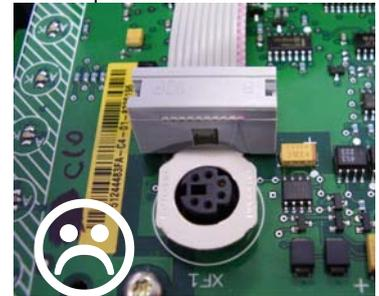
Raccordement incorrect : connecteur décalé vers le bas.
