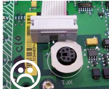
Raccordement incorrect : connecteur décalé vers le haut.
