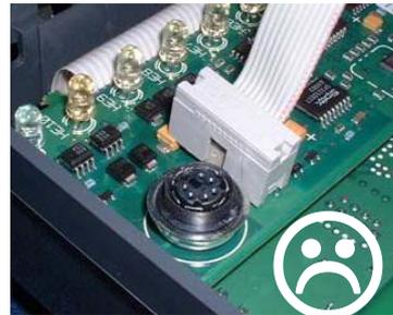
Raccordement incorrect : connecteur décalé vers le haut et en appui sur un composant.
