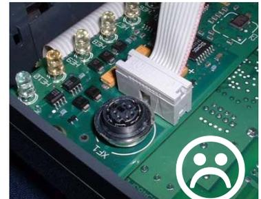
Raccordement incorrect : connecteur décalé vers le bas et aligné sur le bord du circuit imprimé.
