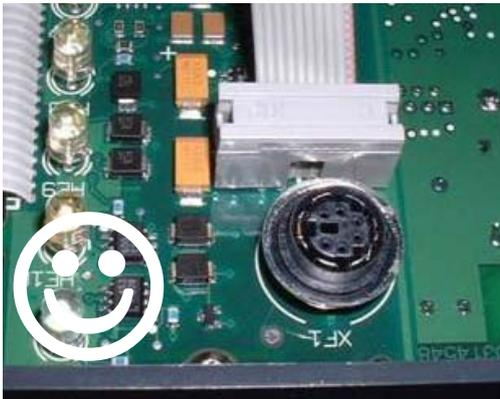
Raccordement correct : connecteur inséré en bordure du composant
